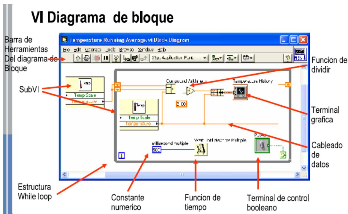
El diagrama de bloque contiene el código fuente grafico. Los objetos del panel frontal aparecen como terminales en el diagrama de bloque. Adicionalmente, el diagrama de bloque
