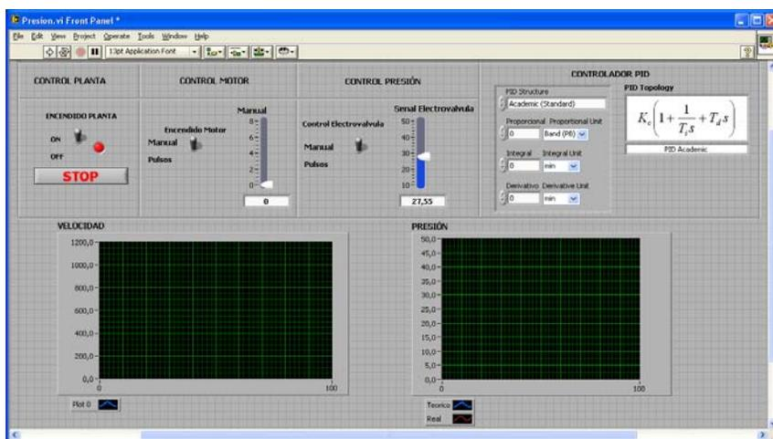
Figura 3.4.1.20: Panel Frontal Para el Control de Presión
