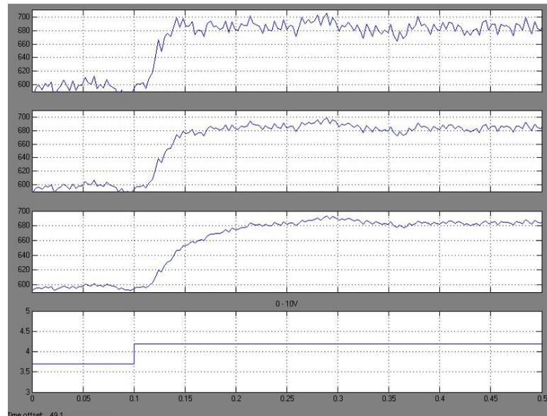
**Figura 2.2.1.5: Salida de Velocidad al utilizar Filtros de 100, 50,25.**
