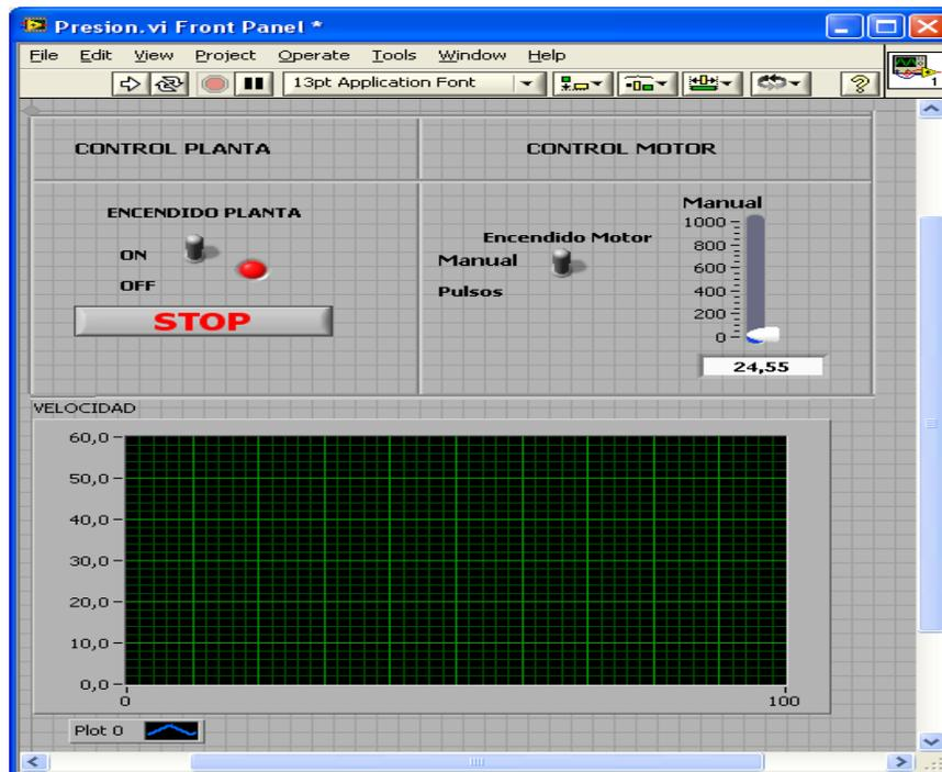
Figura 3.4.1.7: Panel Frontal con Indicador de Velocidad.
