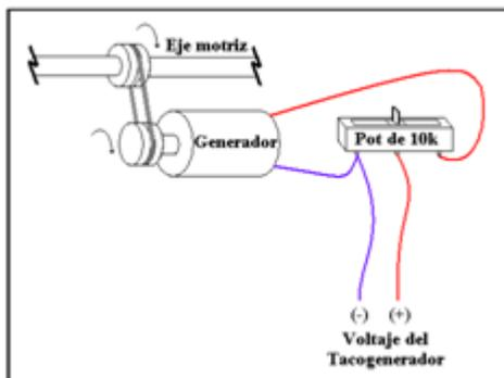
Figura 4.1.3: Bosquejo de los componentes del tacogenerador
