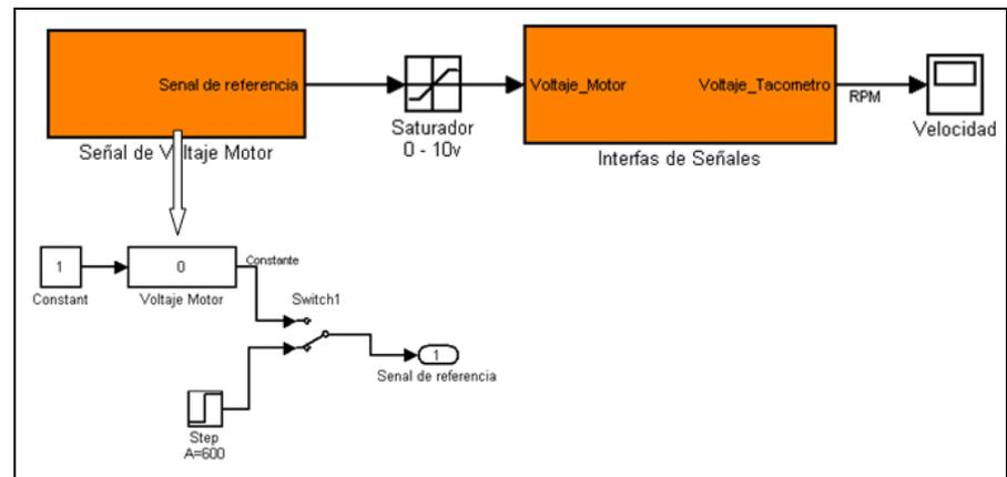
**Figura 3.2.1.6: Encendido de Motor e Indicador de Velocidad**
