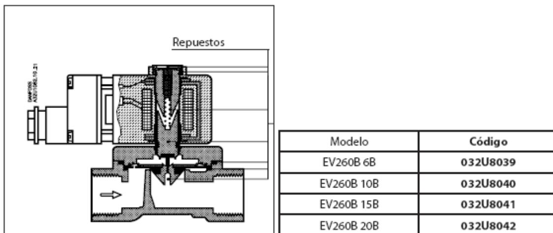
El kit de repuestos contiene p.ej. un botón de bloqueo y una tuerca para la bobina, armadura con clapet, muelle, juntas tóricas y diafragma.
