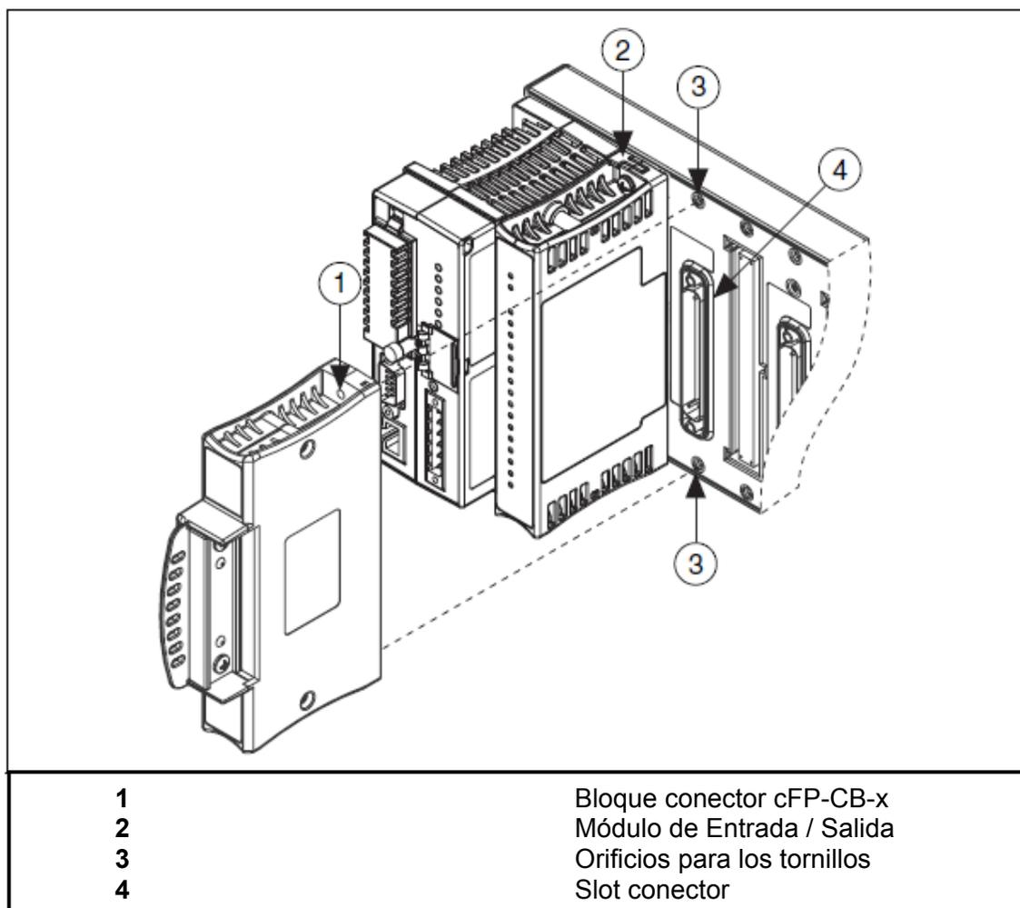
Figura 8.- Instalación de bloques conectores cFP-CB-x en el respaldar
