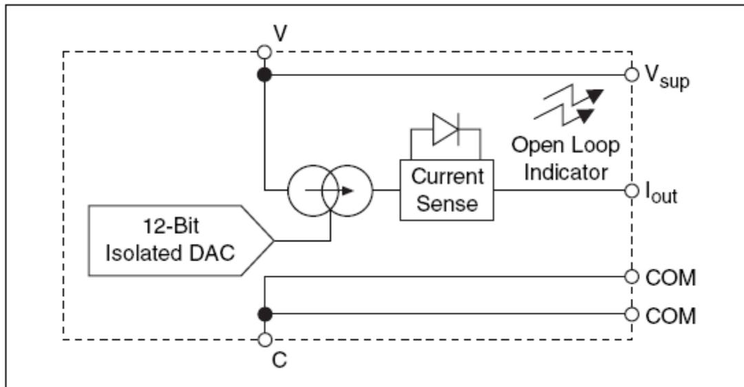
Figura 3.- Circuito de corriente de salida del cFP-AO-200
