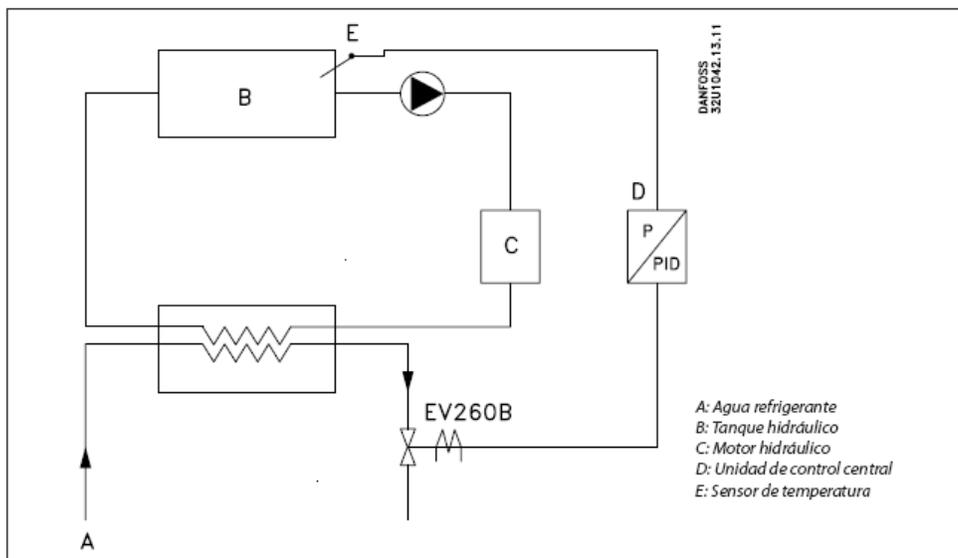
Para controlar la viscosidad y el rozamiento, es importante mantener una temperatura constante del aceite en el motor hidráulico (C). La refrigeración es por lo tanto necesaria regularmente.
