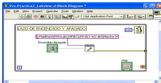
Figura 4.2.4: Diagrama de Bloques Encendido Sistema Electro-Hidráulico
