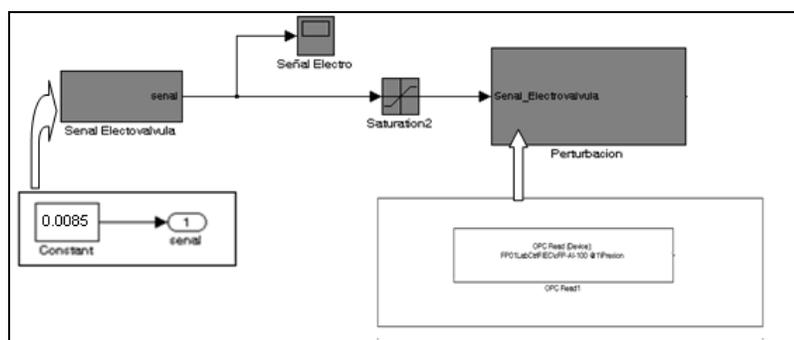
Figura 2.2.1.7: Bloques Generadores de Carga Variable.
