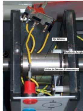
**Figura 1.3.3.4: Conexión Interna.**
