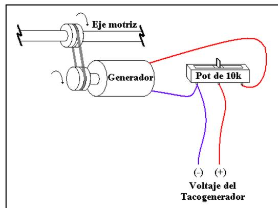
Figura 1.3.3.2: Bosquejo de los Componentes Del Taco generador
