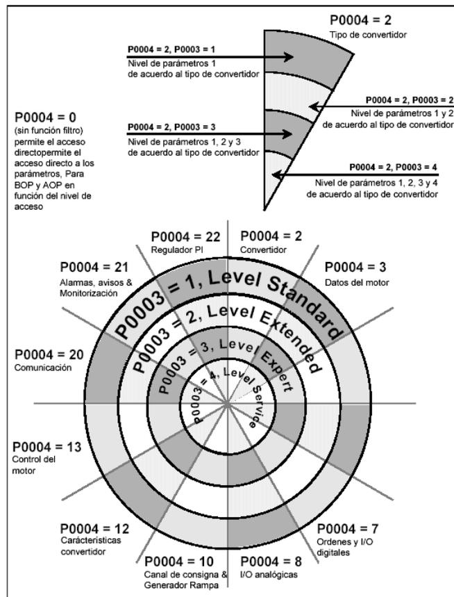
En este cuadro se puede ver el nivel de acceso que podemos tener en los parámetros del convertidor solo con variar el P0003 y otros parámetros adicionales con solo variar el valor de P0004, pero esto depende de la aplicación que queramos realizar, lo cual se pone a consideración del operador.
