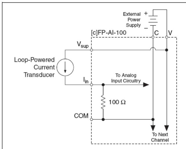
Figura 7.- Corriente con fuente de alimentación externa
