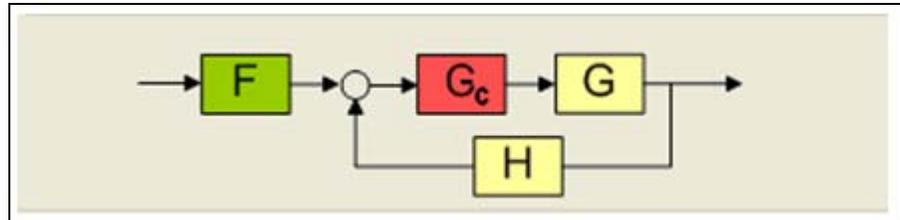
Figura 3.2.2.1: Lazo de Control del Sistema de Presión.
