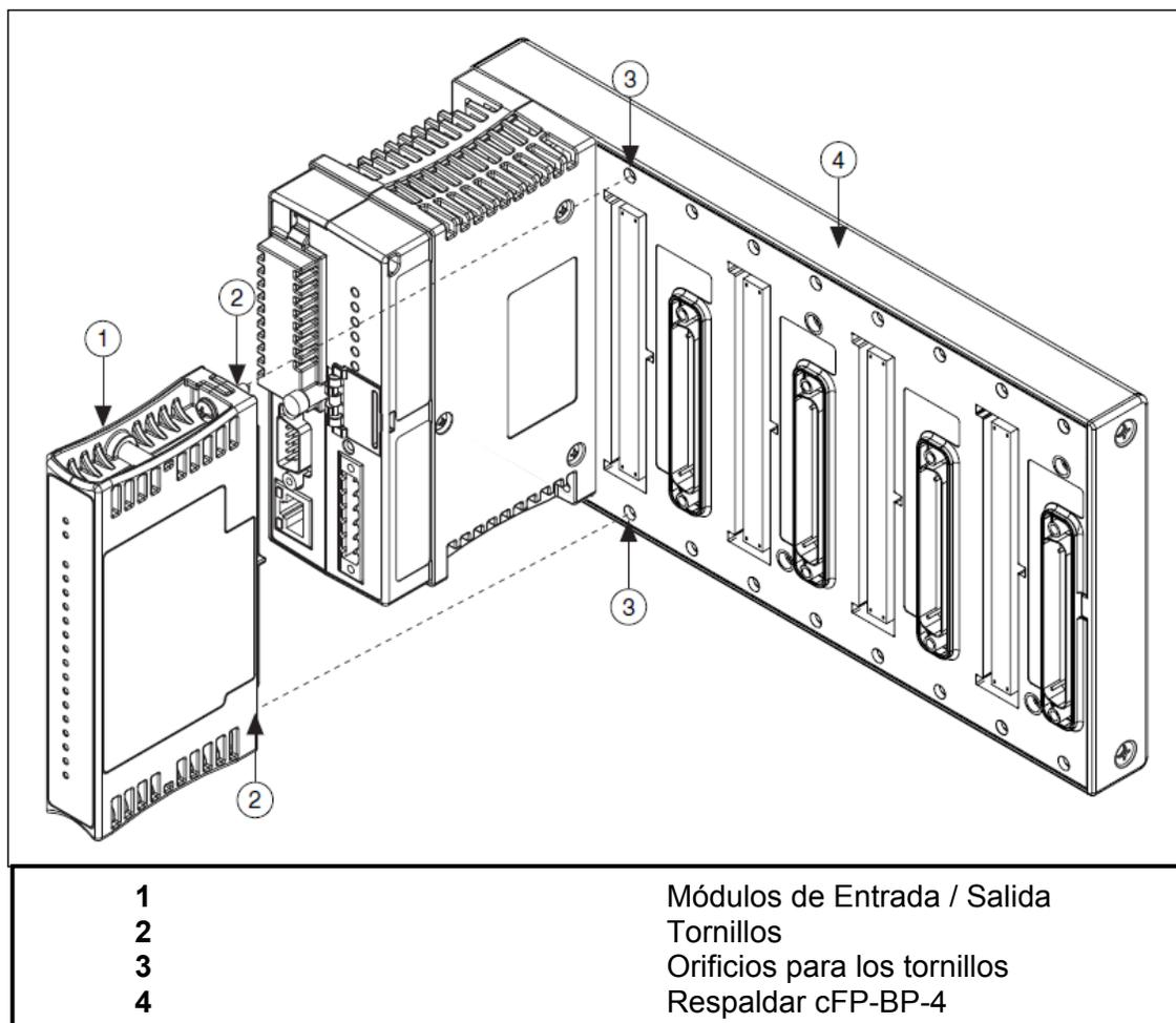
Figura 7.- Instalación de módulos de Entrada / Salida en el respaldar
