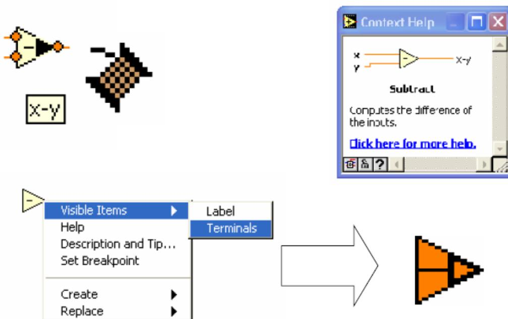
Además de los terminales del panel frontal, el diagrama de bloques contiene funciones. Cada función puede tener múltiples terminales de entradas y salidas. La conexión de estas terminales es una parte muy importante de la programación en LabVIEW.
