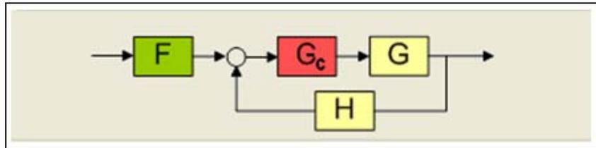
Figura 2.2.2.1: Lazo de Control del Sistema de Velocidad.
