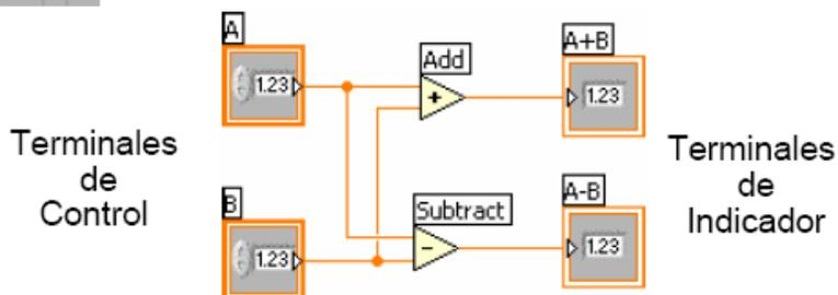
Cuando usted crea un objeto en el panel frontal, una terminal es creada en el diagrama de bloques. Estas terminales le dan acceso a los objetos del panel frontal del código creado mediante el diagrama de bloque.
