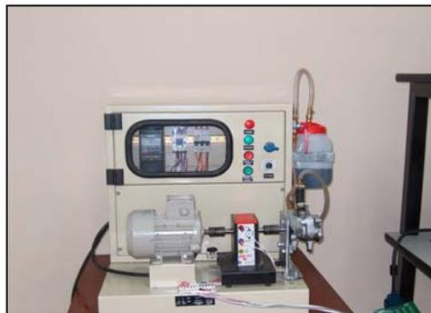
**Figura 1.1.1: Módulo de Control de Velocidad**
