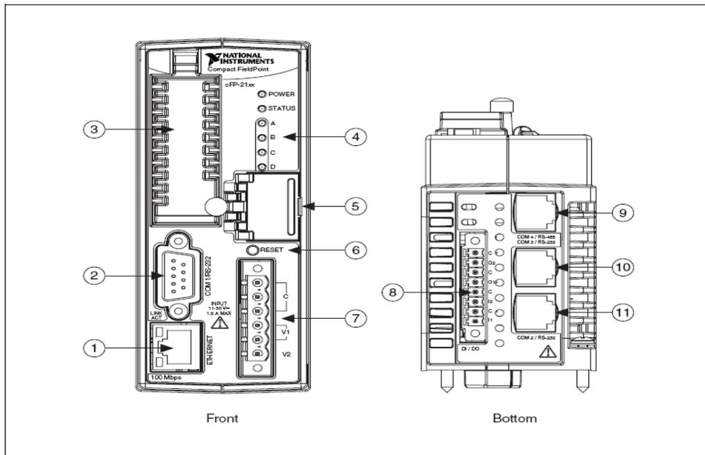
El sistema del Compact FieldPoint (CFP) consiste de un respaldo cFP-BP-x, un controlador cFP-21xx, uno o más módulos Entrada / Salida, uno o más bloques conectores o accesorios. Cada sistema del CFP puede ser accedido por un número ilimitado de computadores y controladores, formando un sistema computarizado distribuido. El máximo número de controladores cFP-21xx que pueden instalarse en un red Ethernet está limitada sólo por la topología de red.
