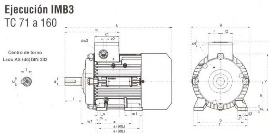
FIGURA 3. DIMENSIONES DEL MOTOR TRIFASICO
