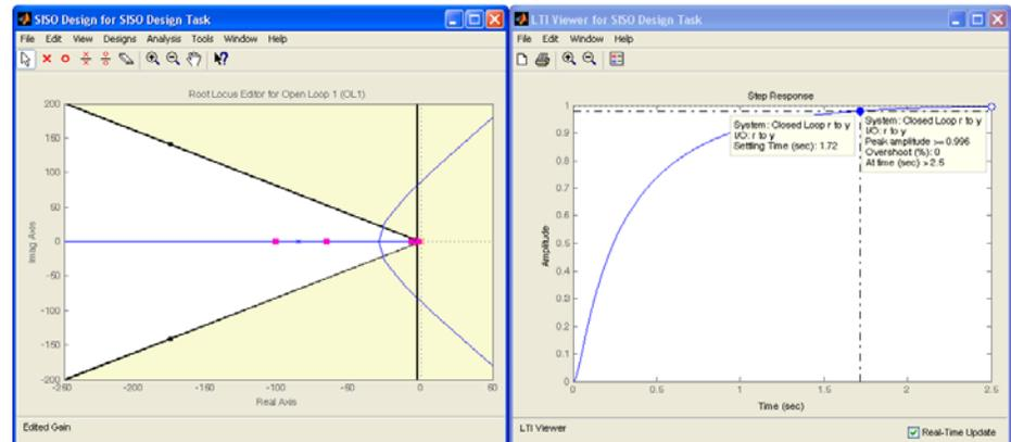
17. En base al modelo matemático de la planta que se obtuvo a través del Identificador de Sistemas, se puede mejorar la respuesta del sistema en la herramienta SISO, seleccionando parámetros como el tiempo de estabilización, el sobre nivel porcentual, etc., es decir de acuerdo a la necesidad del proceso a ser controlado.
