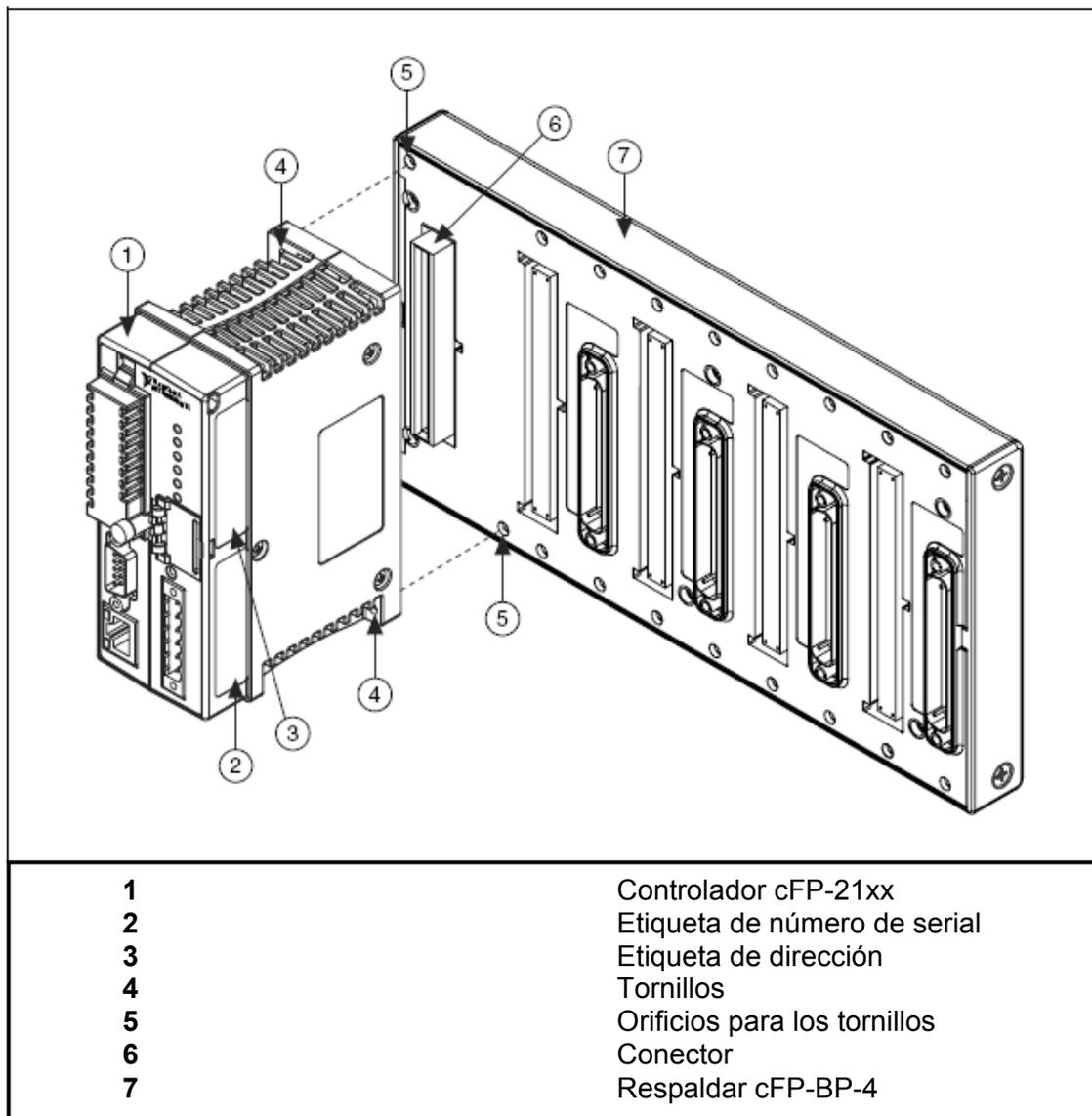
Figura 6.- Instalación del Controlador cFP-21xx sobre el respaldar cFP-BP-4
