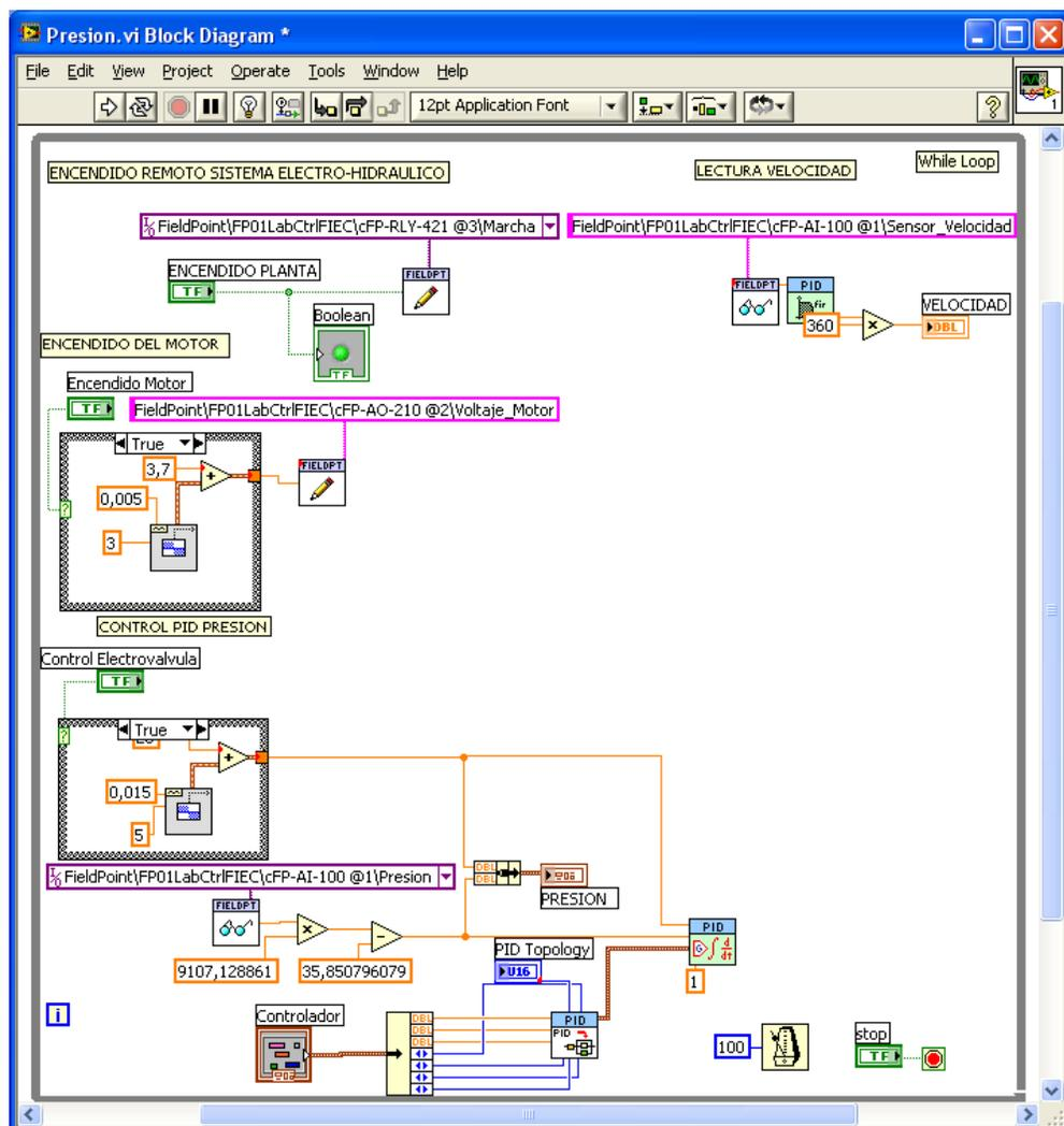
Figura 3.4.1.18: Diagrama de Bloques con Bloque PID
