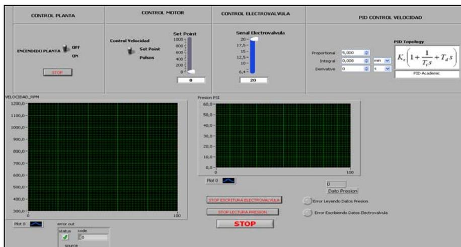
Figura 4.2.27: Panel Frontal para Control de Velocidad.
