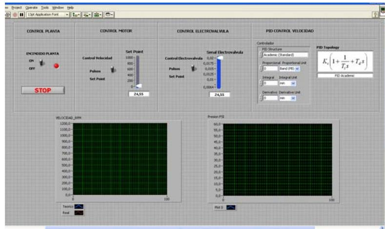
Figura 2.4.1.20: Panel Frontal para el Control de Velocidad.
