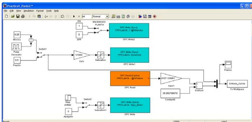
Figura 4.1.41: Modelo en Matlab-Simulink Para Identificación de Presión
