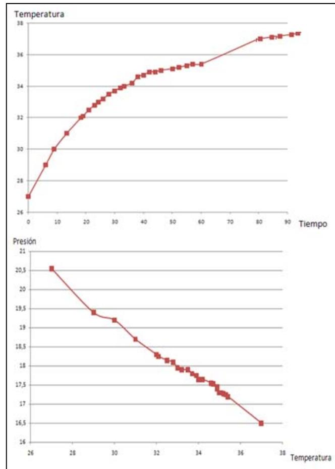
**Figura 3.2.1.1: Efecto de Perturbación Externa Temperatura en Presión**
