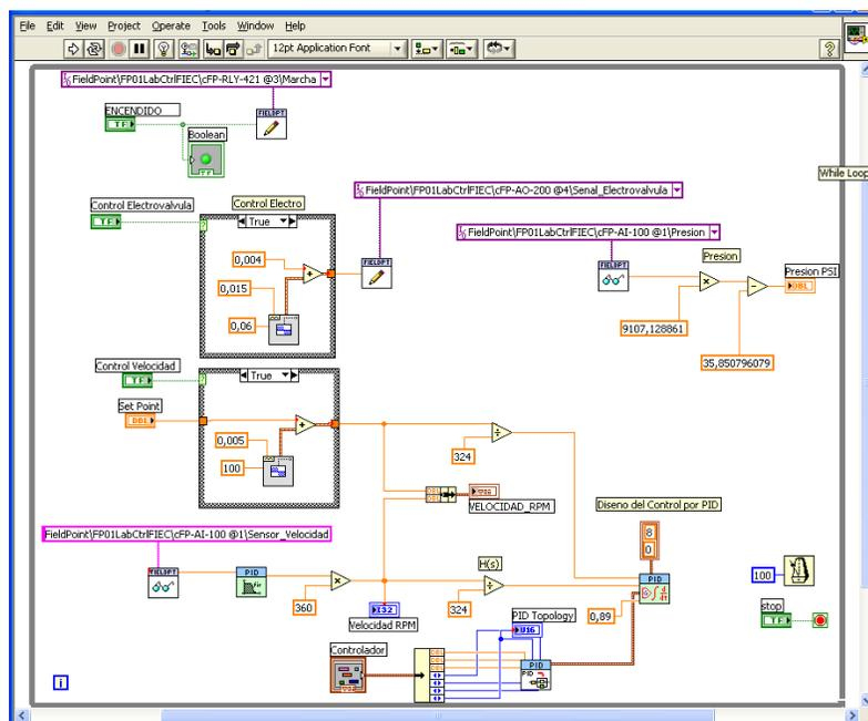
Figura 2.4.1.18: Diagrama de Bloques con Bloque PID
