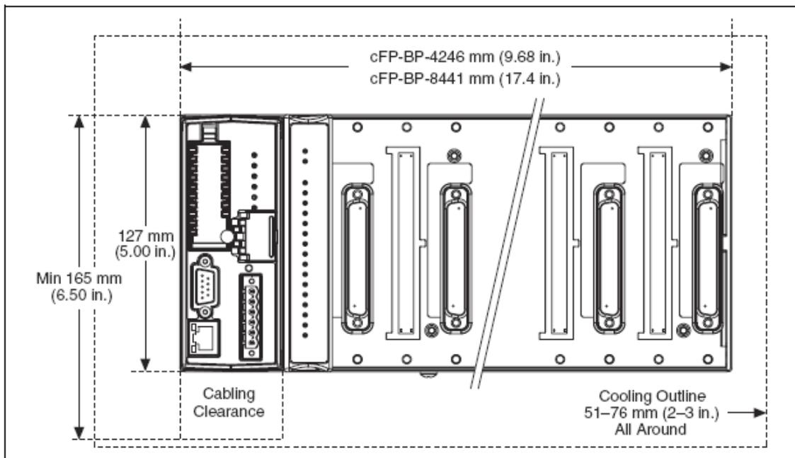
Figura 3.- Respalda cFP-BP-x con cFP-21xx instalado, vista frontal con dimensiones.
