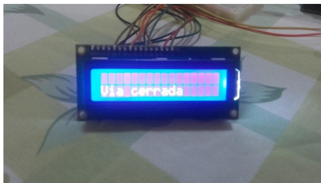
Figura 4.12. Mensaje mostrado para el cierre de la vía.
