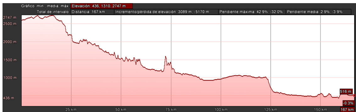
Figura 2. 5 Perfil longitudinal de la ruta Ambato-Tena: terreno llano y ondulado
