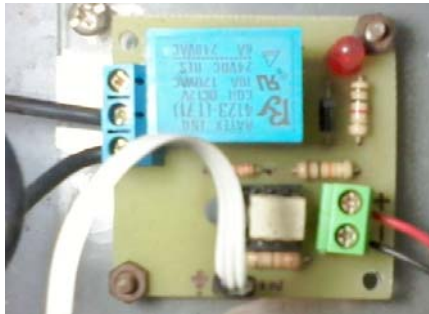
Figura 1.5 Módulo utilizado para el accionamiento de relés de potencia.
