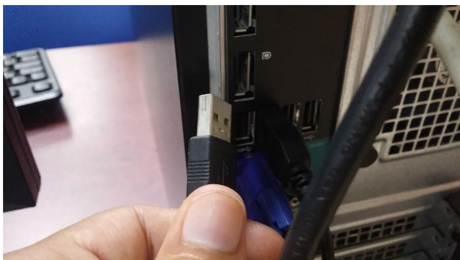
Figura 4.3: Desconexión del mouse.
