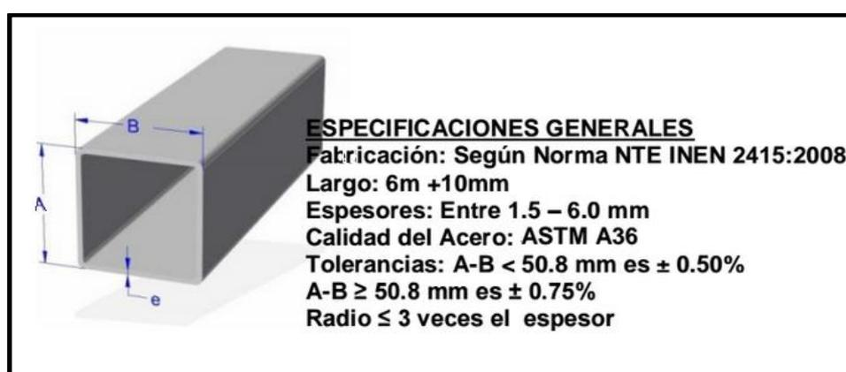
**Figura 5:** Especificaciones generales de tubo estructural cuadrado
