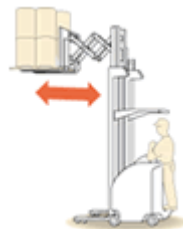
Figura II-9 MONTACARGAS TIPO REACH
