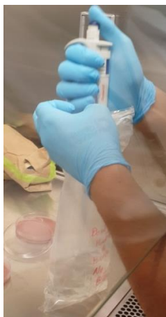
Figura 3.42 Recolección de 2µL de la muestra de agua que contiene la bacteria patogénica E. Coli
