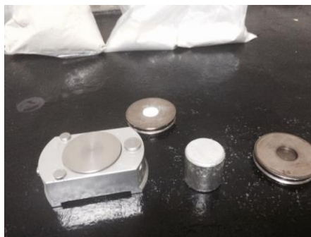
Figura 3.39 Preparación del porta muestra para medición en el difractómetro de rayos X
