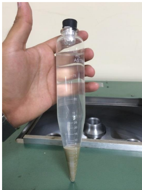
Figura 3.30 Tubo de centrifuga y separación de fases
