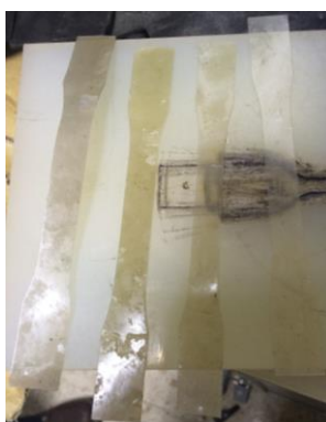
Figura 3.36 compuestos poliméricos de Zeolita intercambiada con iones plata al 1, 2 y 3% con PEBD y PEBD puro
