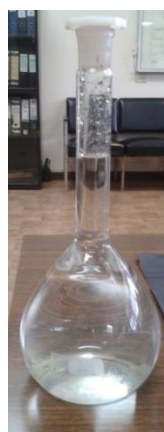
Figura 3.31 Solución de \text{AgNO}_3 0.05 M
