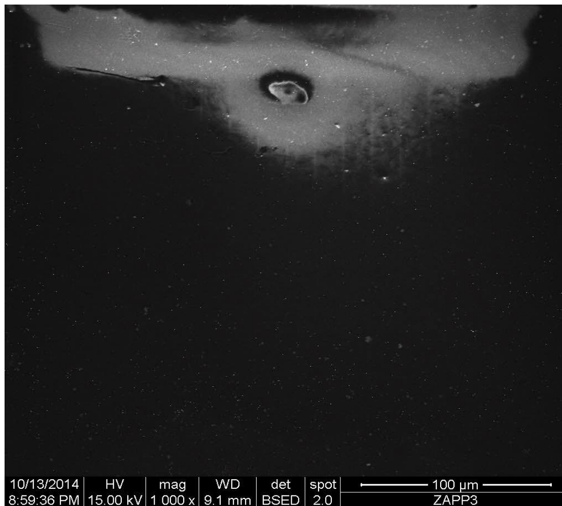
Figura A. 76. SEM Fotomicrografía polipropileno y zeolita intercambiada con iones plata al 3% magnificado a 1000x.
