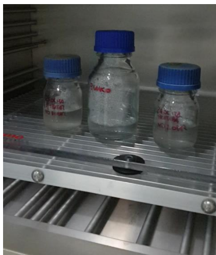
Figura 3.49 Tres recipientes conteniendo la bacteria E. coli previamente inoculada y la zeolita a analizar
