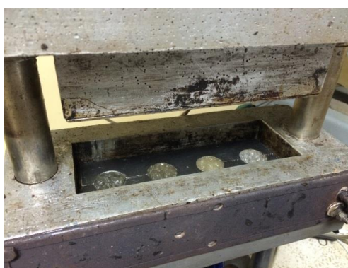
Figura 3.34 Equipo de presión mecánica con temperatura
