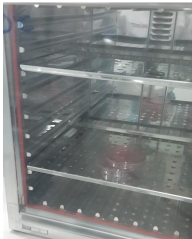
Figura 3.45 Agares con agua contaminada en la incubadora
