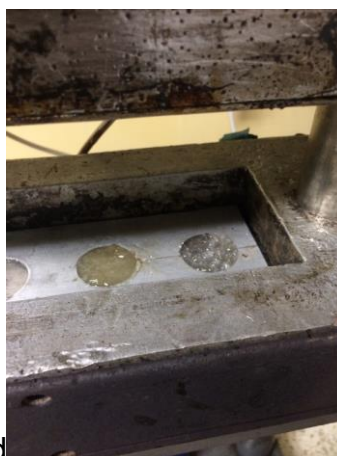
Figura 3.40 Elaboración de discos para análisis de difracción de rayos X
