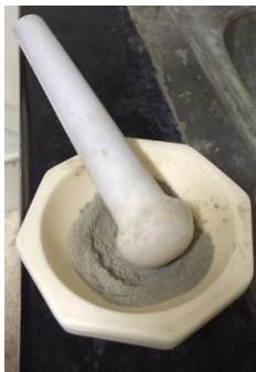
Figura 3.38 Homogenización de la muestra de zeolita y 10% de ZnO ingresada
