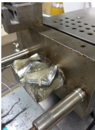
Figura 3.33 Masas mezcladoras del reómetro y composición poliméricas
