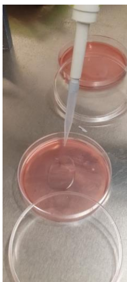
Figura 3.43 Inyección de la muestra de agua en el agar MacConkey
