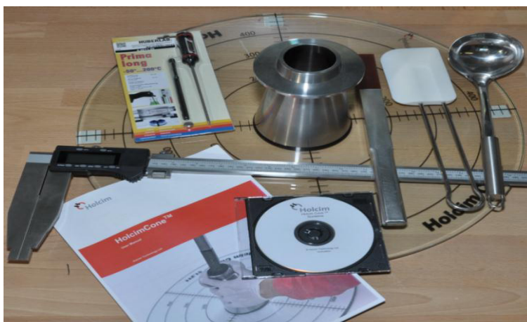
Figura 3.1: HolcimCone y materiales, Laboratorio de Ensayos Especiales, Centro Técnico del Hormigón (CTH), Holcim-Planta San Eduardo.
