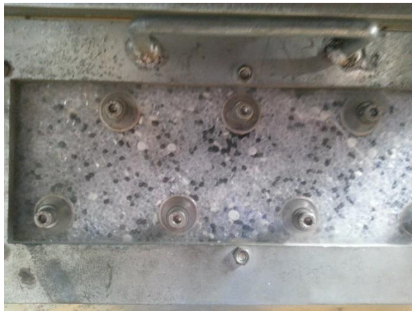
Figura 4.11.: Imagen de mezcla de PS virgen con XPSd pelletizado y aditivos después de ingresar a la tolva para la fabricación de muestras de láminas extruidas de XPS
