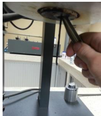
Figura 3.8.: Material bajo análisis saliendo del túnel de calor para ser cortado y pesado.
