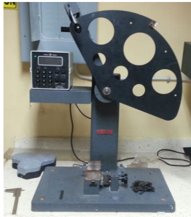
Figura 3.12.: Impactómetro, Laboratorio de plásticos, ASEPLAS
