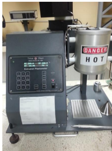
Figura 3.7.: Plástómetro, Laboratorio de plásticos, ASEPLAS
