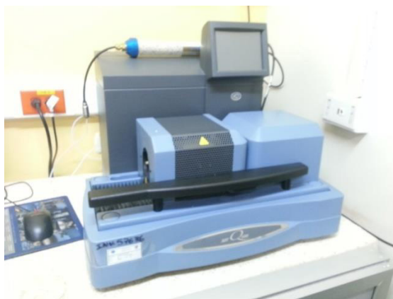
Figura 3.9.: Equipo de DSC/TGA o Calorímetro, LEMAT
