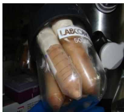
**Figura 29.** Liofilización
