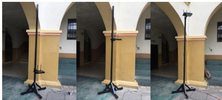
Figura 3.6. Estructura metálica para variar la altura del transmisor.
