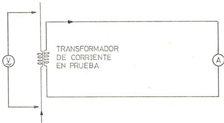
Fig. 8.8 Circuito para la prueba de aislamiento del transformador de corriente.
