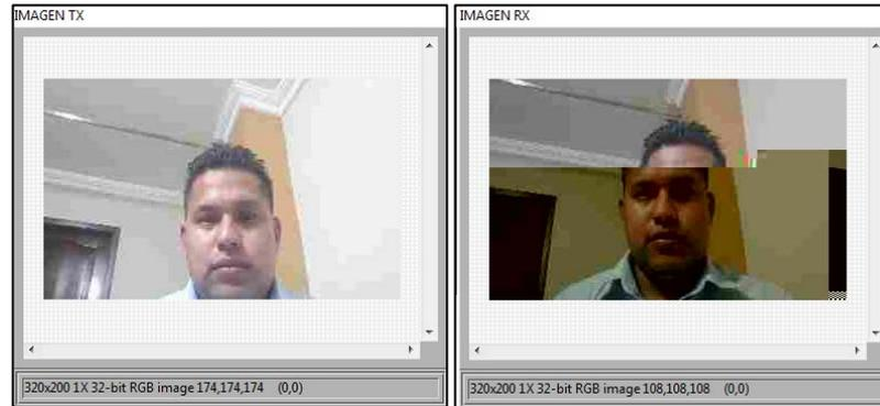
**Fig. 16. Ejemplo de transmisión y recepción con nivel de ruido AWGN de -8 dB.**
