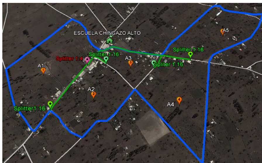
Figura 3.7: Ubicación de splitters de 1:4 y 1:16.
