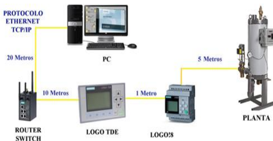
Figura 2.1: Topología de control tipo bus del proyecto
