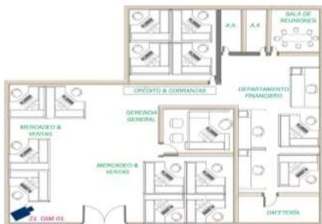
Figura 2.4: Ubicación de cámaras en Zona 1 Edificio Administrativo 1
