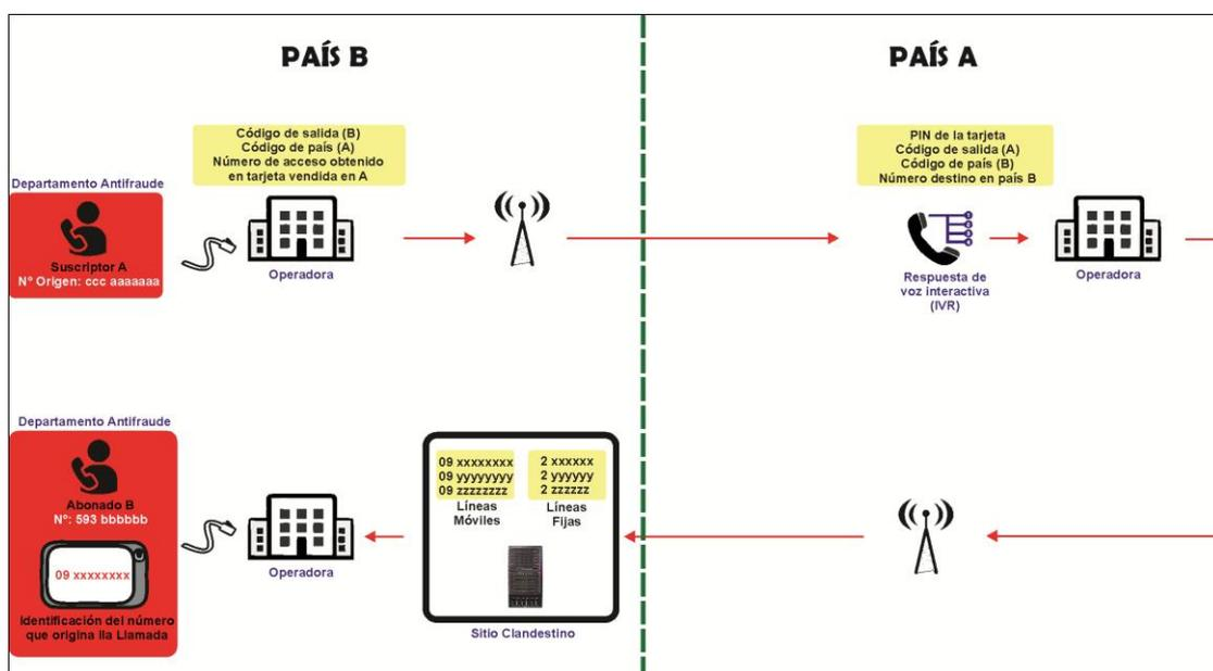
**Figura 2.3: Diagrama del sistema Loop de Llamadas automatizado**
