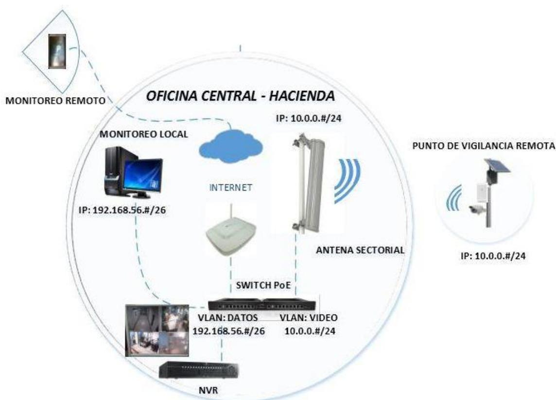
**Figura 2.1: Diseño de Solución de Video-vigilancia inalámbrica**
