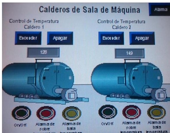
Figura 22 Aplicación de alarmas en el Panel View 600
