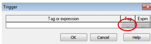
**Figura 12: Ventana de Trigger para configuración de Alarmas**
