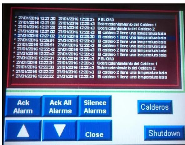
Figura 29: Display de “alarmas” con la selección del botón “Ack All Alarms”
