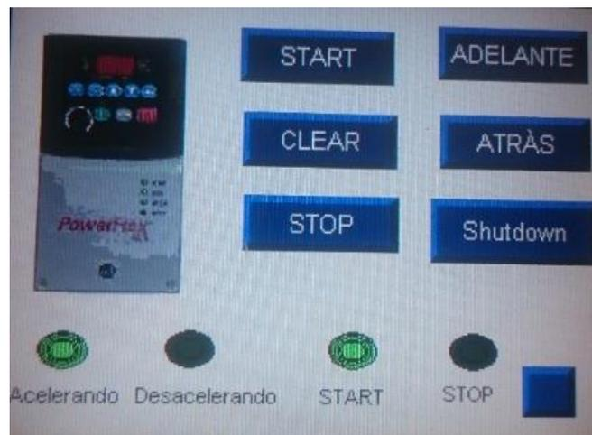
**Figura 49: Modo “Accelerating” del variador en el HMI**
