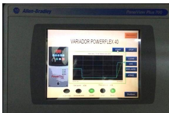
**Figura 13: Cambio de frecuencia en el variador**
