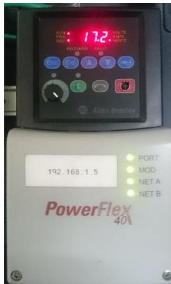
Figura 51: Modo “Decelerating” del variador Power Flex 40
