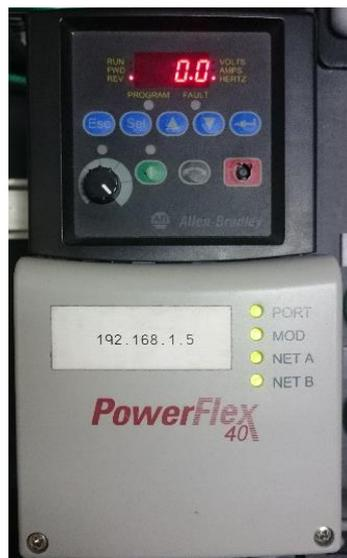
Figura 47: Modo “Stopped” del variador Power Flex 40
