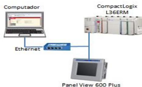
**Figura 1: Conexiones de equipos**
