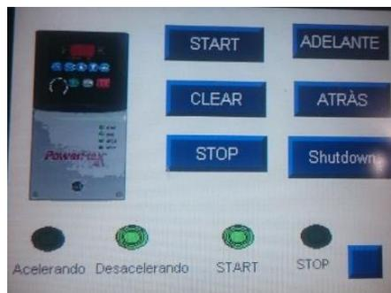
Figura 53: Modo “REVERSE” del HMI
