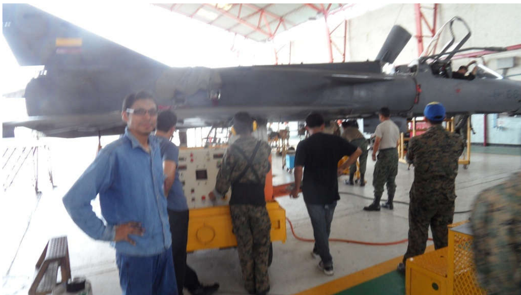
Figura 12. Prueba del banco hidráulico con el avión CHEETAH
