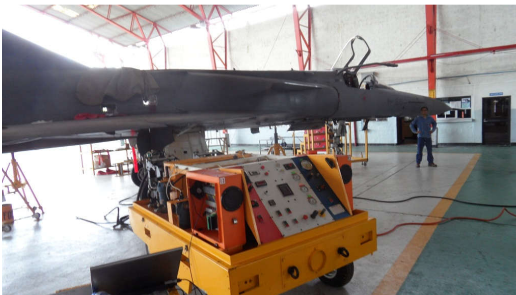
Figura 5. Avión CHEETAH preparado para pruebas hidráulicas
