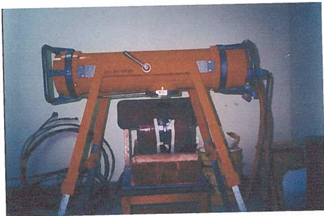
Fig. 38 Equipo de ensayo radiográfico de la tubería soldada
