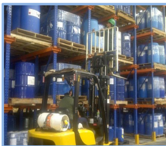
Foto 3 MONTACARGAS ELEVANDO A PERSONAL
