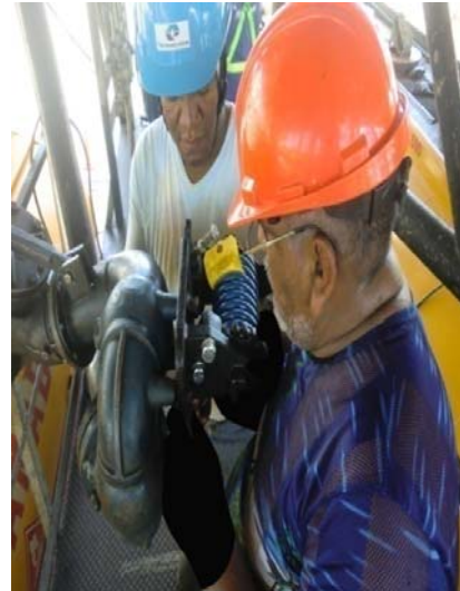
10.- Reemplazar por un nuevo balancin del brazo de carga.
