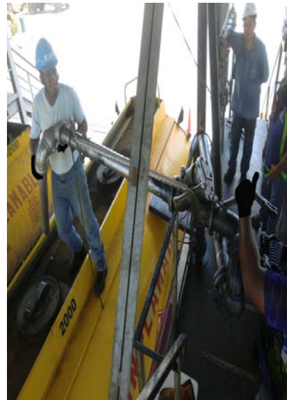
12.- Colocar el brazo de carga a su posición correcta.
