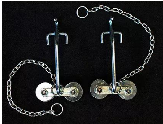
Figura 3.13 Garrucha para transporte de productos agrícolas
