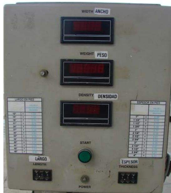
Figura 1.3: Panel frontal del equipo de medición de densidad.
