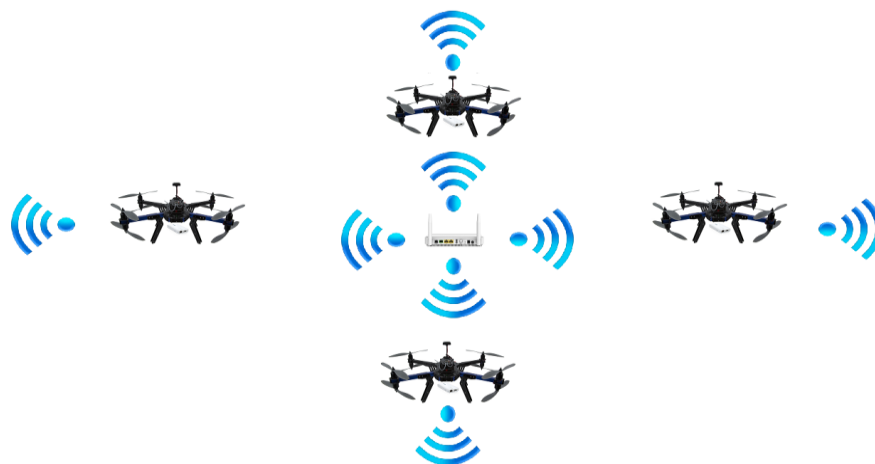
Figura 2.18: Ubicación de drones a 90^\circ para expandir la cobertura.
