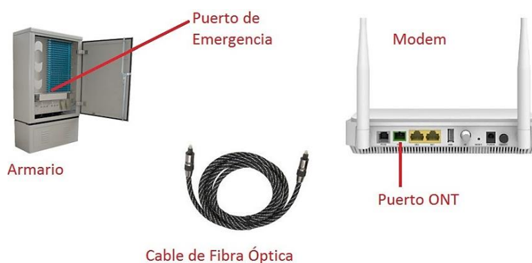
Figura 2.15: Conexión entre el puerto de emergencia y el modem GPON.
