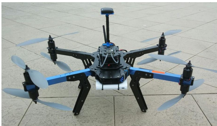
Figura 2.42: Presentación final del drone equipado con el access point.
