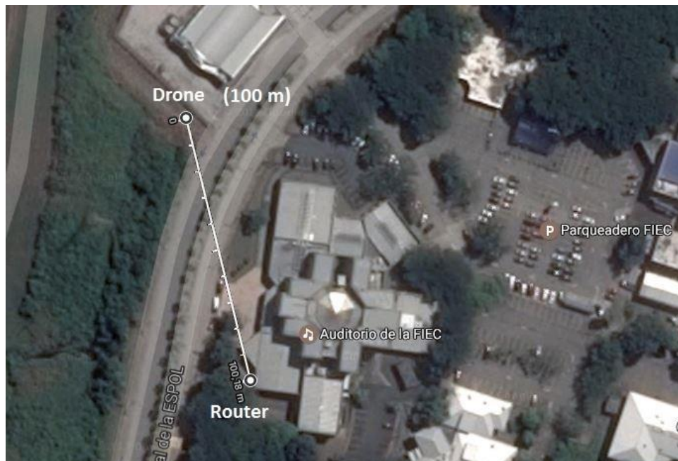
Figura 2.50: Distancia de la componente horizontal entre el router y el drone ilustrada en Google Maps.
