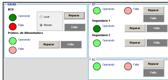
Figura 3.62. Inhabilitación de la BCU debido a falla en el secundario 1.
