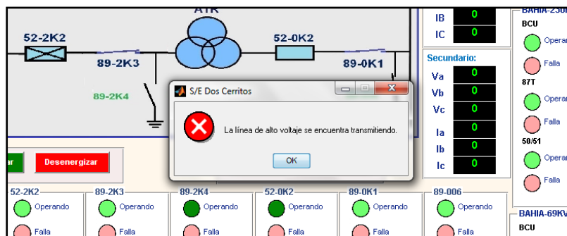
Figura 3.41. Aviso de error: No se puede ejecutar acción. Abrir el interruptor.
