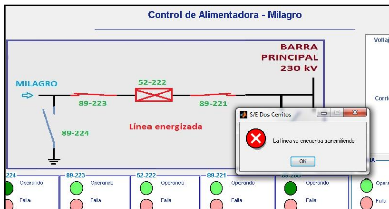
Figura 3.34. Mensaje de error al intentar abrir la línea con un seccionador.
