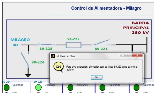
Figura 3.21. Aviso: No se puede cerrar el seccionador. Solucionar problema primero.
