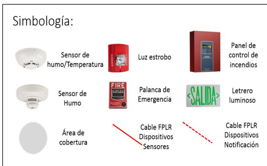
Figura 2.28: Simbología general de detección de incendios
