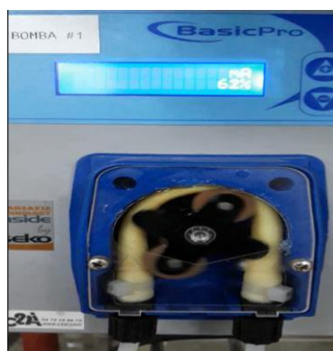
Figura 4.15: Bomba 1 trabajando al 62% mientras trabaja el controlador PD discreto
