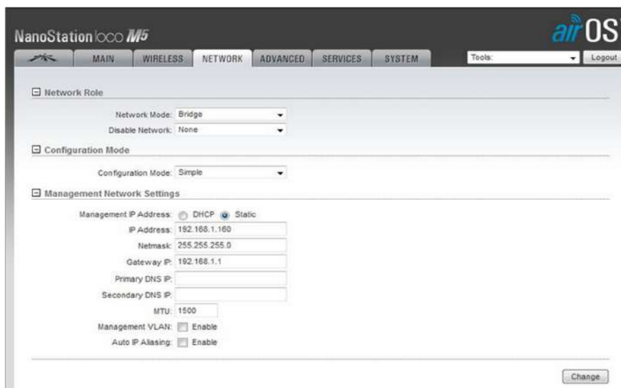
Figura 3.30 Ejemplo de configuración de la opción Network (Loco M5).
