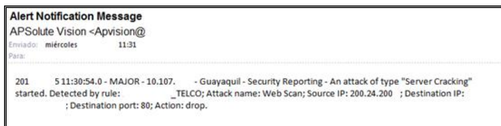
Figura 3.2 Mensaje del mitigador de ataques y su acción ejecutada
