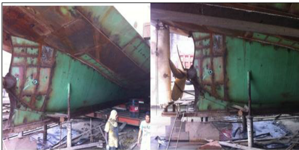
Figura No. 14.- Embarcación atunera con bulbo de popa
