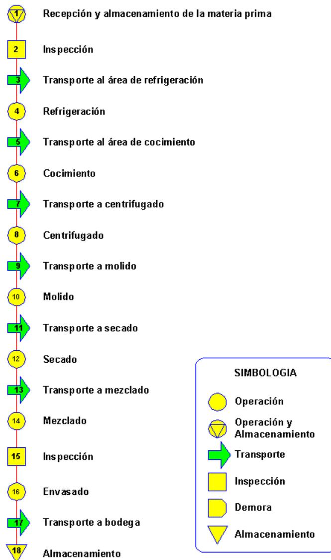
**Figura 2.1. Flujo del Proceso de Producción**
