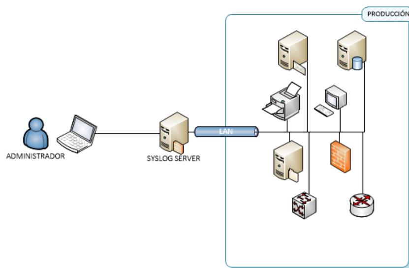
Figura 4.4 Representación de SyslogServer para almacenamiento.
