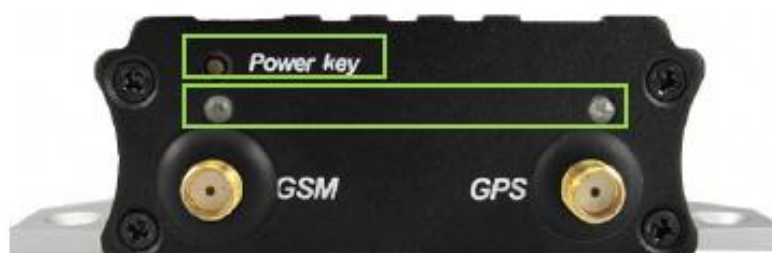
Figura 2.6 Indicadores Led del MVT380
