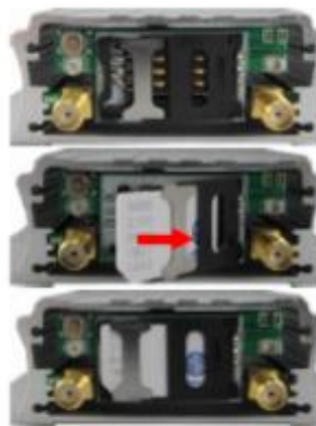
Figura 2.5 Como insertar el chip en el MVT380
