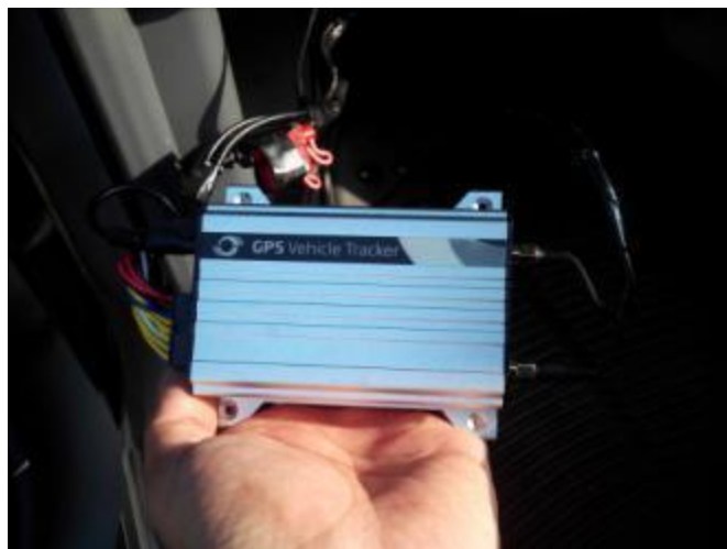
Figura 4.28 Rastreador MVT380 instalado.
