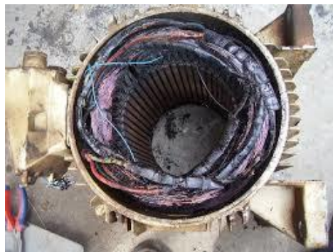
Figura 1. 2. Motor eléctrico averiado.
