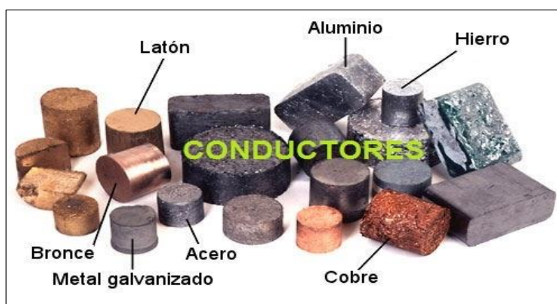
Figura 2.11: Conductores de electricidad.
