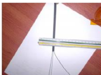
Diametro de la F.O. 6.5mm, peso de la F.O. 50 kg/km
