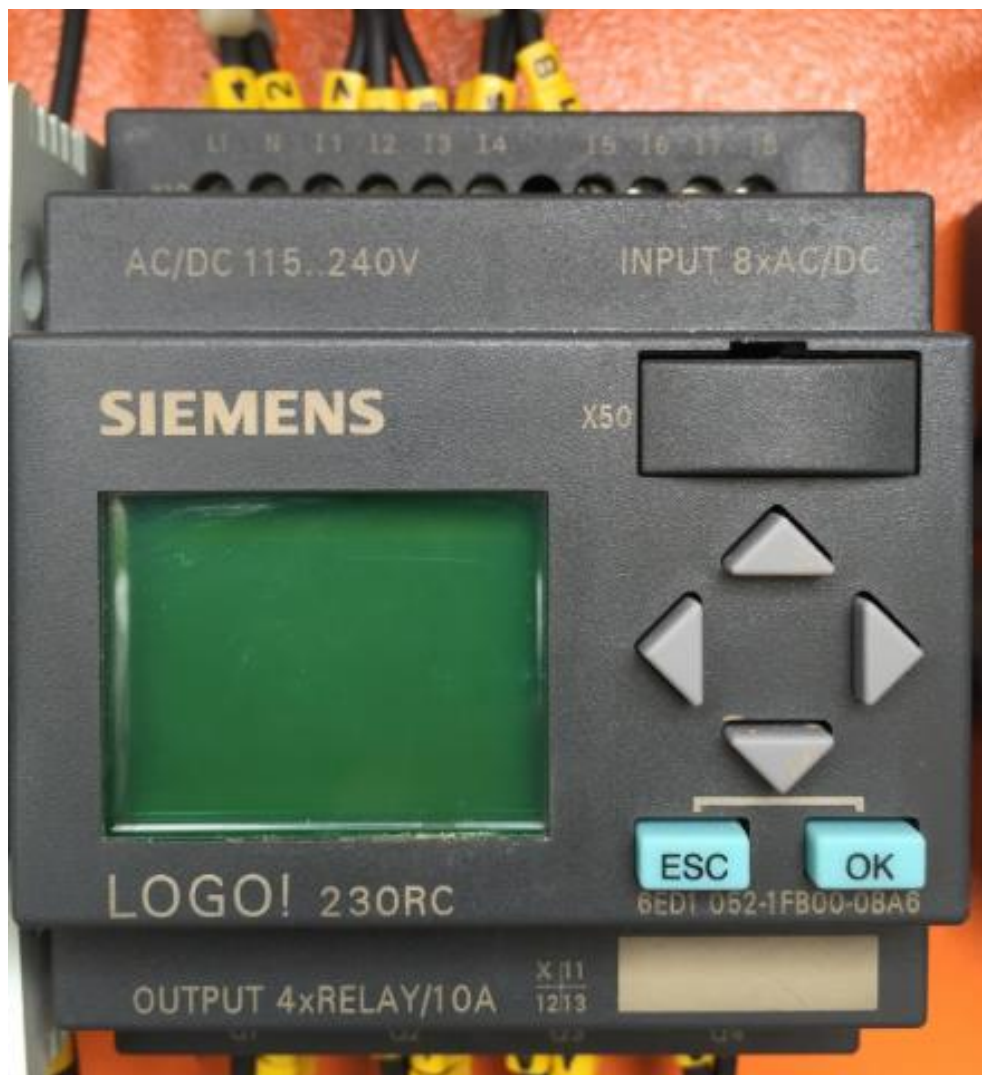
Figura 1.5: Controlador del sistema de bombeo.
