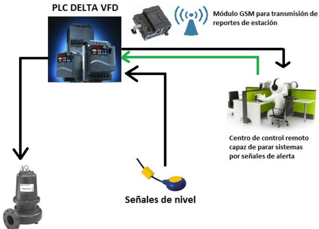
Figura 2.3: Arquitectura para estación de bombeo.
