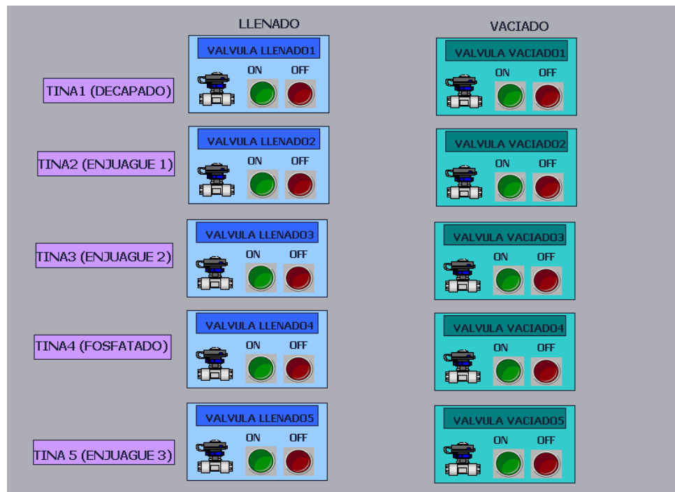
Figura 2.17: Ventana con electroválvulas para el llenado y vaciado de las tinas del proceso
