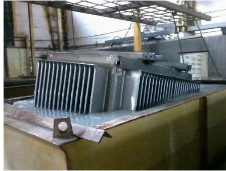
Figura 1.5: Estructura de transformador siendo colocada en la tina de enjuague
