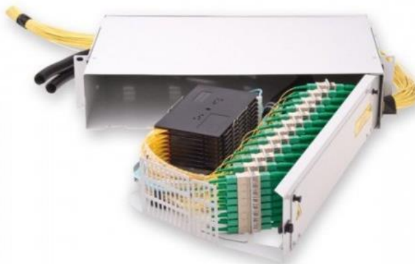
Figura 3.11: ODF de 96 puertos [22]
