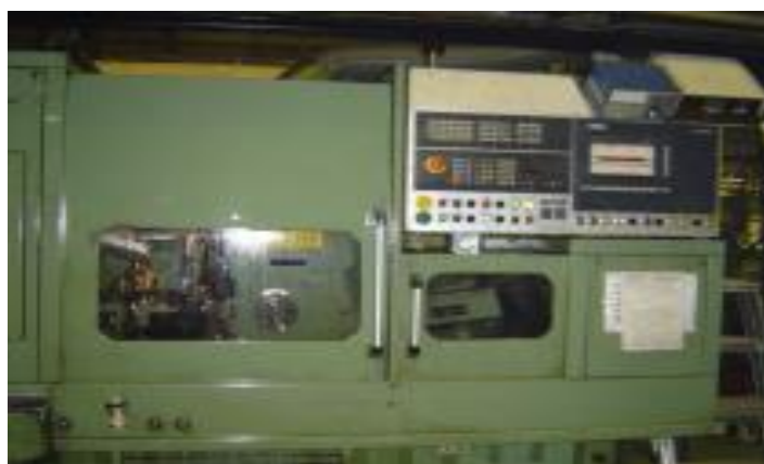
Figura 1.7 Ejemplo de automatización programable con máquina de fabricación de manguetas.
