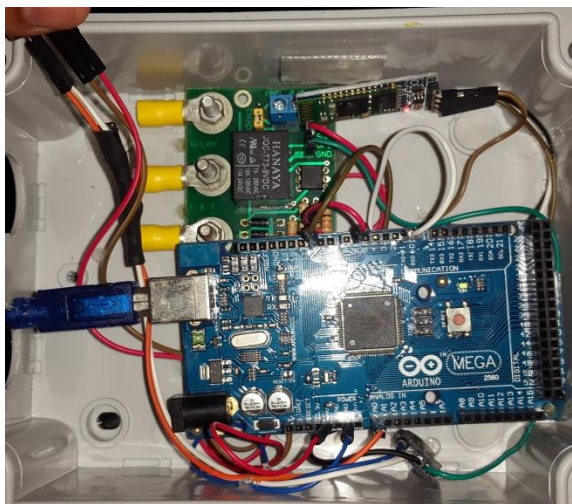
Figura 3.3 – Conexión Sensor MQ3 en Arduino Mega
