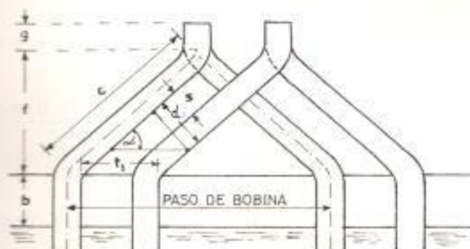
FIG. N° 2.6 CABEZAL DE BOBINA DE ARMADURA
