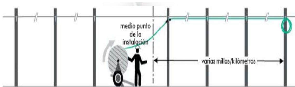
**Figura 2.26. Extracción de cable al punto medio**
