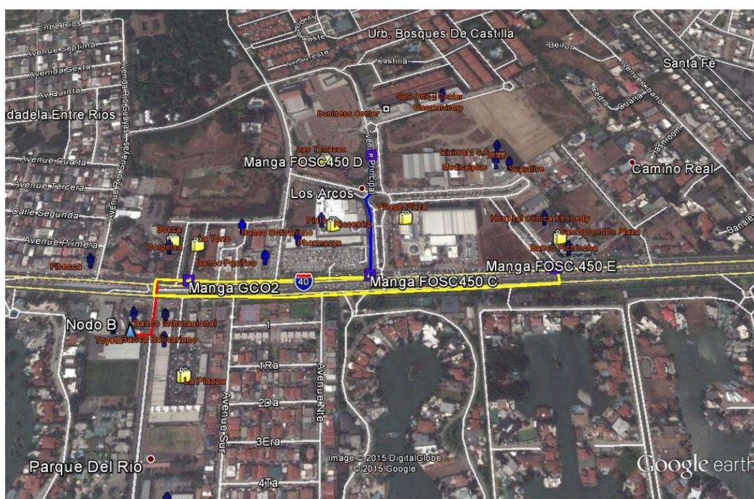
**Figura 3.10 Tendido de la Fibra y ubicación de las Mangas de Empalme parte #1**
