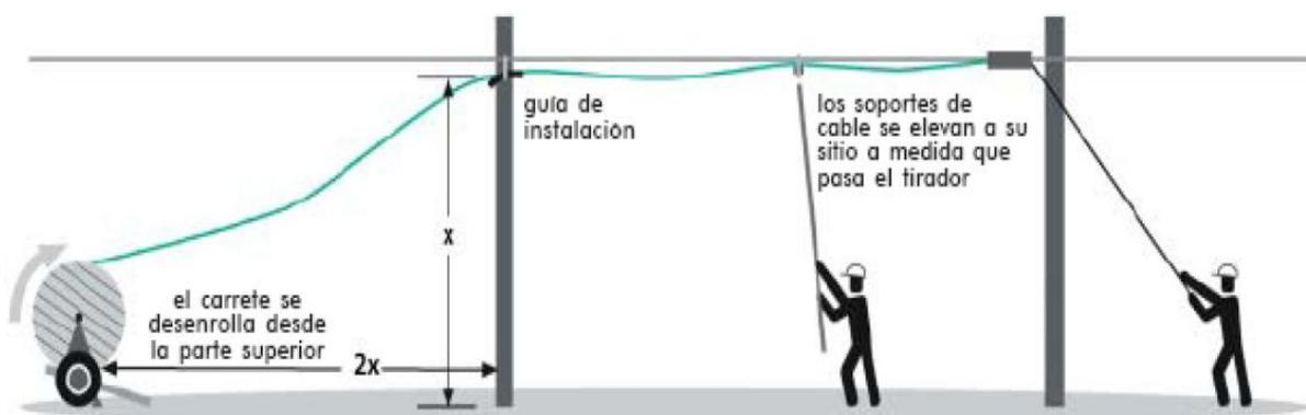
Figura 2.28. Método de enrollado retractable
