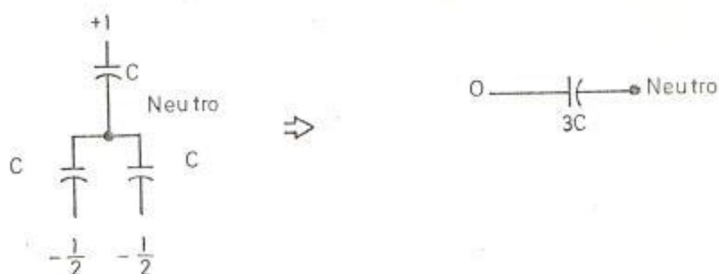
FIGURA 5.8 Simplificación del Neutro de un Banco Trifásico Balanceado
