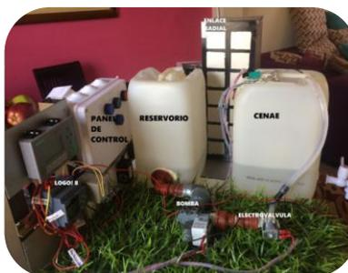
Figura 4.4: Maqueta Telecontrol de sistema de bombeo
