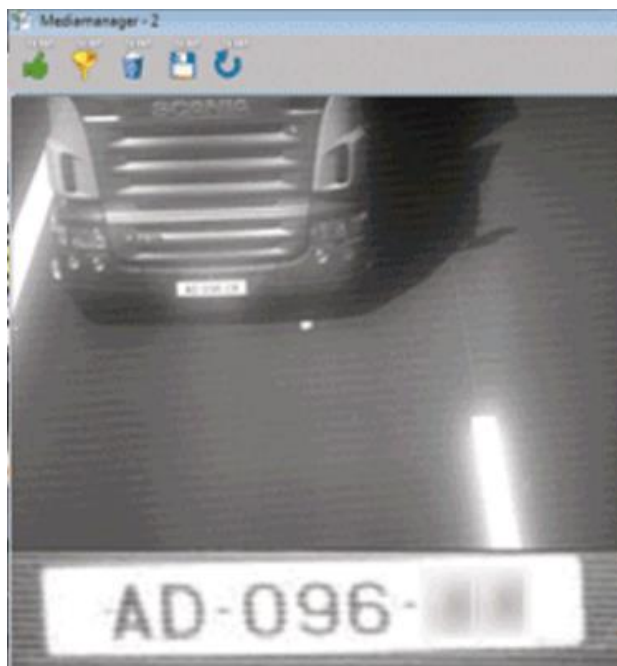
Figura 2.52: Detección de placas vehiculares [14].
