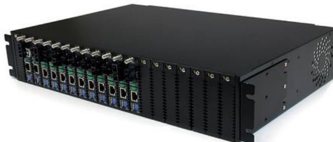
Figura 3.5: Chasis Media Converter StarTech ETCHS2U con 20 Ranuras
