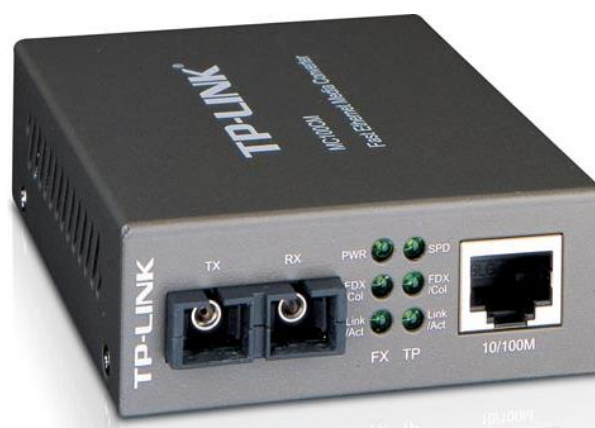
Figura 3.9: Media converter de fibra óptica a UTP.
