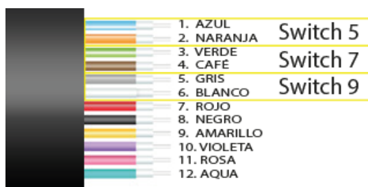
Figura 2.12 Asignación de hilos de la segunda Fibra óptica multimodo que conectan el centro de cómputo con los Bloques 2 y 3
