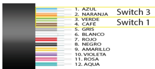
Figura 2.9 Asignación de hilos de la primera fibra óptica multimodo que conectan el centro de cómputo con el bloque 1
